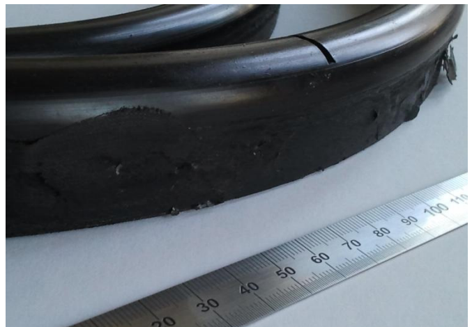
Abbildung 10: Schaden an Nutringdichtung HNBR
