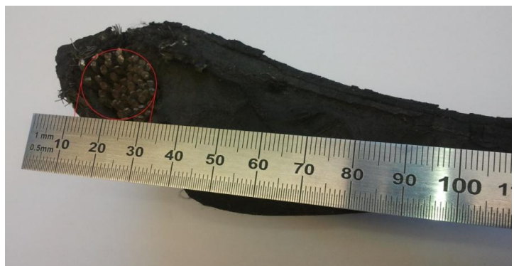
Abbildung 36: „LKW-Reifenchip“ mit Stahlleinlage
