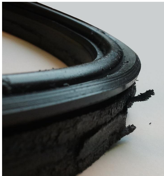
Abbildung 8: Schaden an Nutringdichtung (NBR / HNBR)
