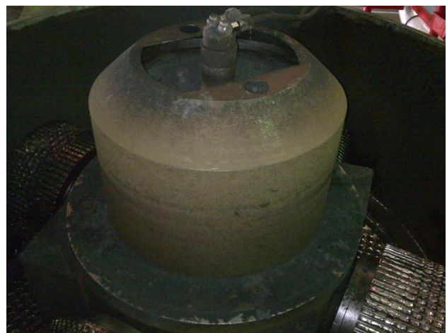
Abbildung 1: Verschmutzung innerhalb der Kollermühle
