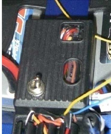
Abbildung 3-34: Eingebauter 2-poliger Kippschalter
