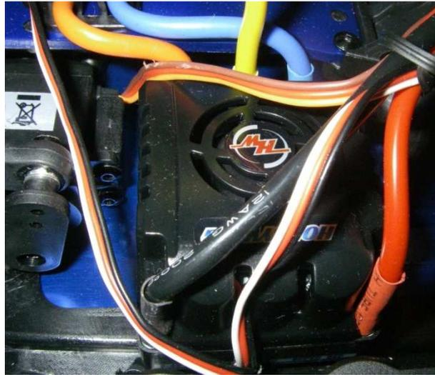
Abbildung 2-7: ESC und Servo mit den Anschlüssen von den Akkus und dem Empfänger
