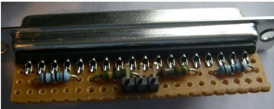
Abbildung 3-39: Elektronische Bausteine auf die Rückseite der Platine zum Anlötén gesteckt
