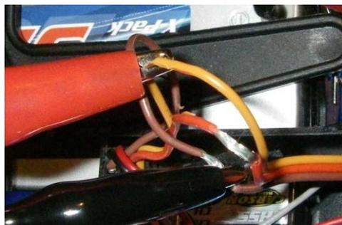
Abbildung 3-26: Messung des braunen und gelben Kabels
