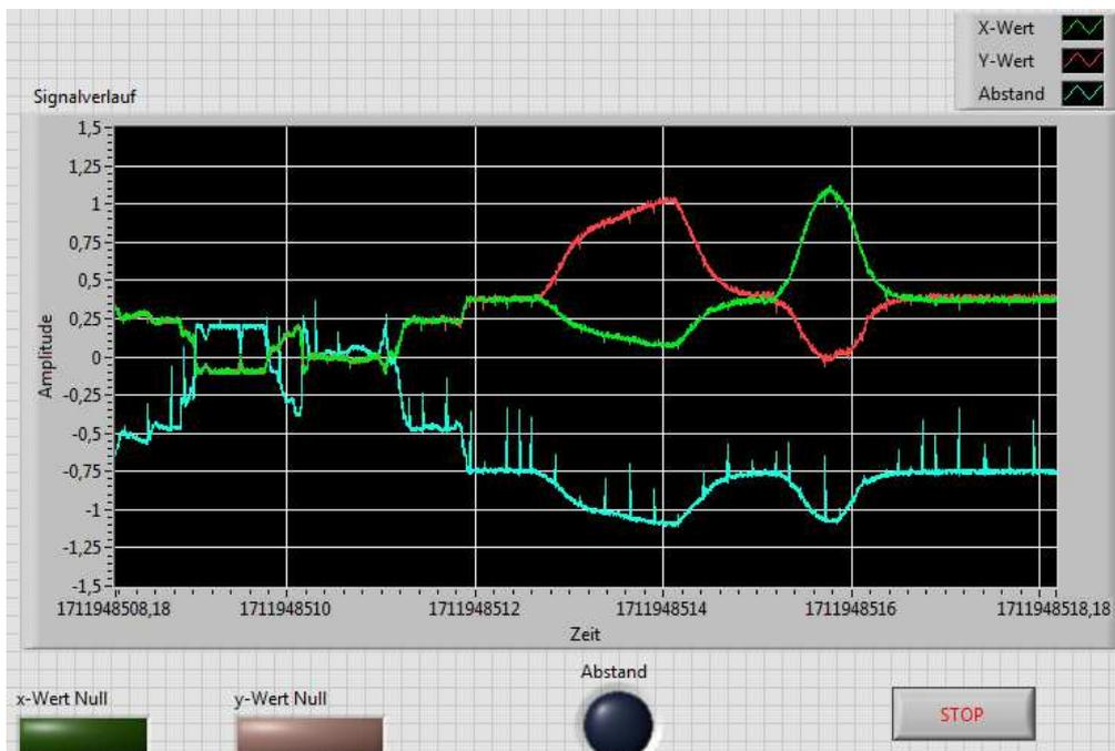
Abbildung 4-5: Signalverlauf nach hinzufügen der abgeschirmten Kabel
