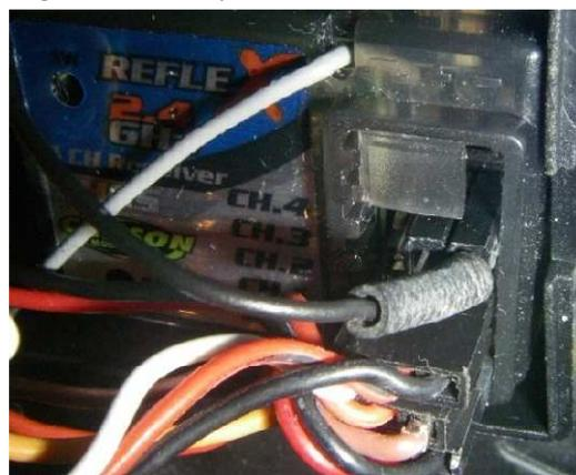
Abbildung 3-35: Installation des zusätzlichen Ground am Sender (CH.4-Kanal)
