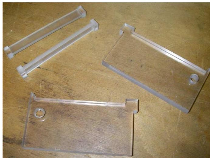
Abbildung 3-52: Fertige Haltevorrichtung für die Chassis vor dem Einbau
