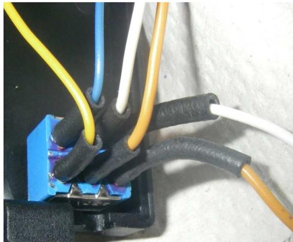
Abbildung 3-32: Angelötete Anschlüsse der PWM-Kabel an den Kippschalter
