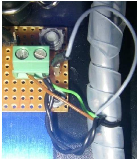
Abbildung 4-4: Anschließen der Abschirmungen an den Ground
