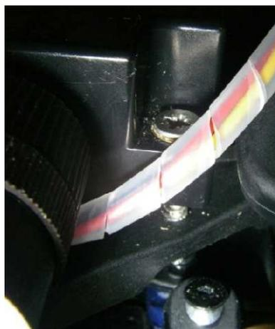
Abbildung 3-5: Vordere Verschraubung des Kippsensors
