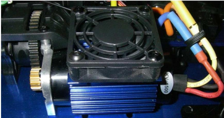
Abbildung 2-8: Brushlessmotor mit Lüfter und Anschlüssen vom ESC und Übergang zum Getriebe
