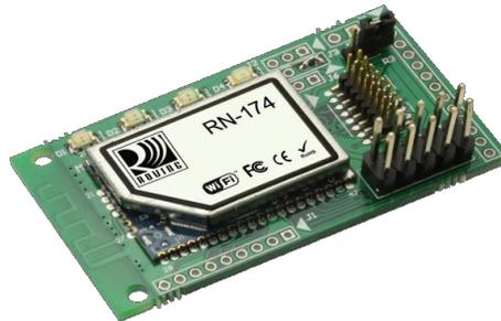
Abbildung 3.2: RN-174 Development Board von Roving Networks (aus [RN-1742012](#) (2012, S. 1))
