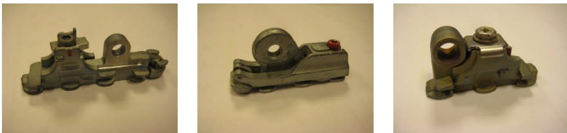
Abbildung 2.7: Varianten der hinteren Befestigungselemente eines Sitzfußes
