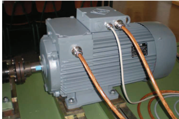
Abbildung 3-13: Asynchronmaschine SPER 132 MX4 SW TPM HW
