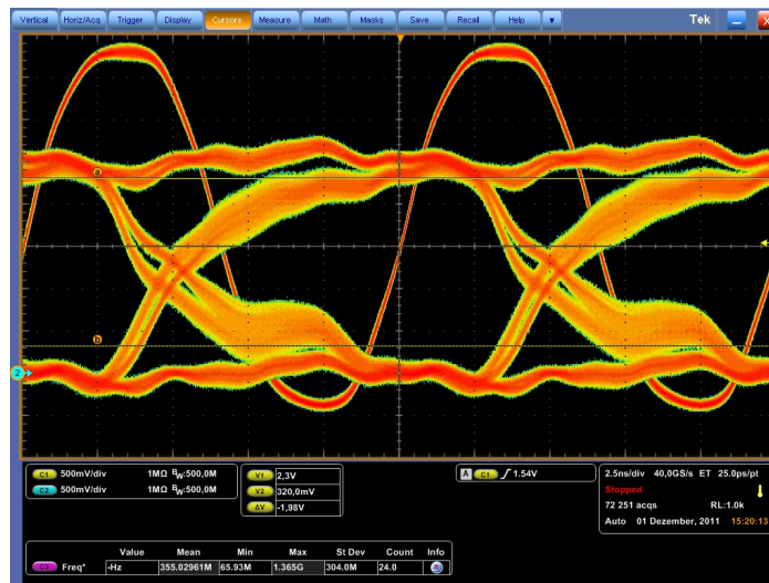
Bild 4.7.: Augendiagramm der Datenleitungen mit Daten-Takt
