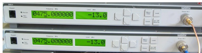
Bild 8.7.: Sinusquellen zur Generierung der Trägersignale
