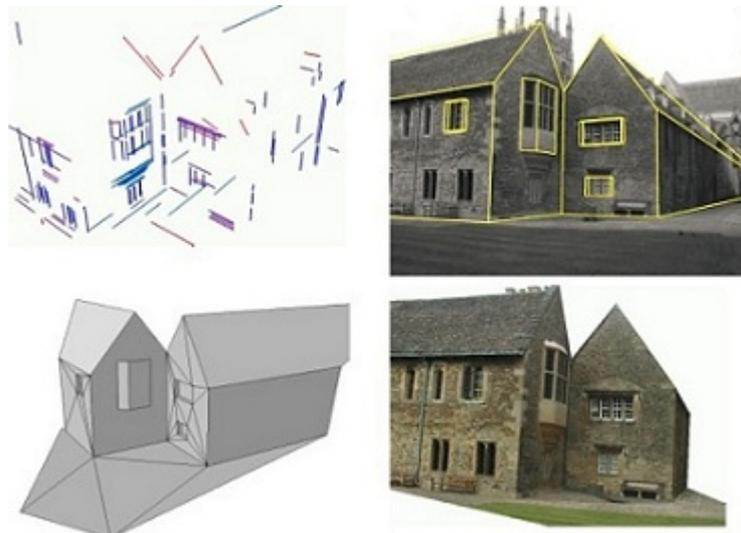
Abbildung 3.3: Automatische Architekturrekonstruktion mit Hilfe von 3D-Linien und Ebenen. Quelle: [Werner and Zisserman, 2002]
