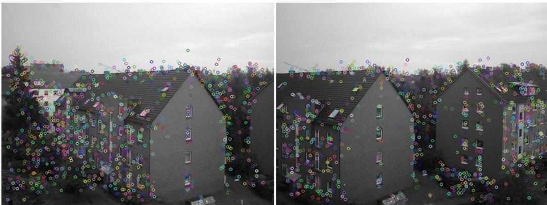
Abbildung 6.5: Testergebnisse von SURF-Merkmal-detektor(zweite Bildpaar, Auflösung 640 × 480)
