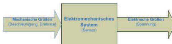
Abbildung 4.1.: Signalverarbeitungsrichtung im Sensorsystem
