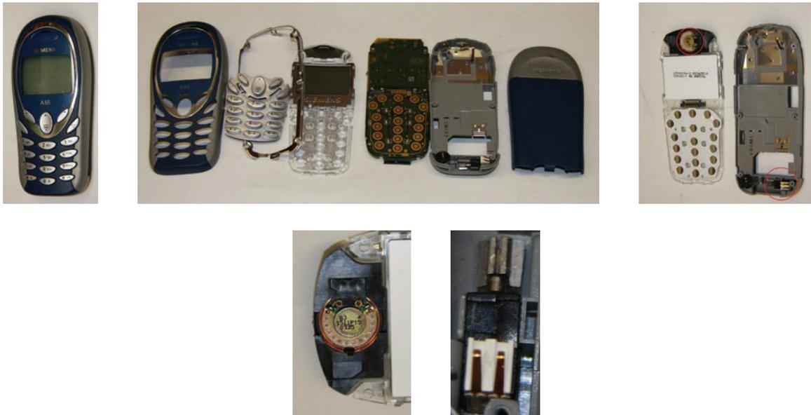
**Abb. 2.2.9:** Schritte des Zerlegens eines Mobiltelefones in Lautsprecher (unten links) und Vibrationsmotor (unten rechts)
