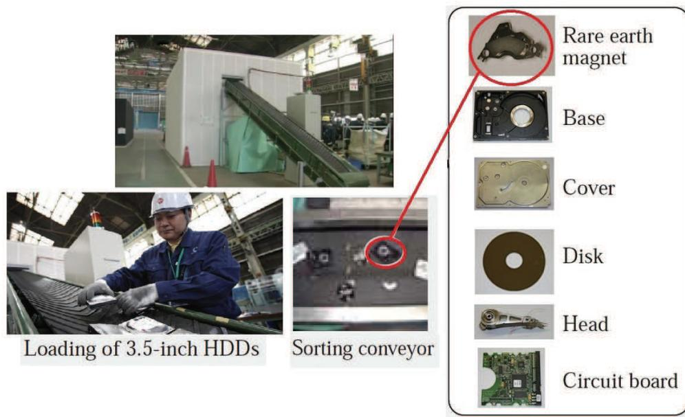
**Abb. 4.7.2:** links: Maschine und Prozessschritte zur Isolierung von Neodymmagneten aus Festplatten; rechts: Einzelteile der Festplatte nach Verlassen der Maschine (Nemoto et al., 2011; verändert)
