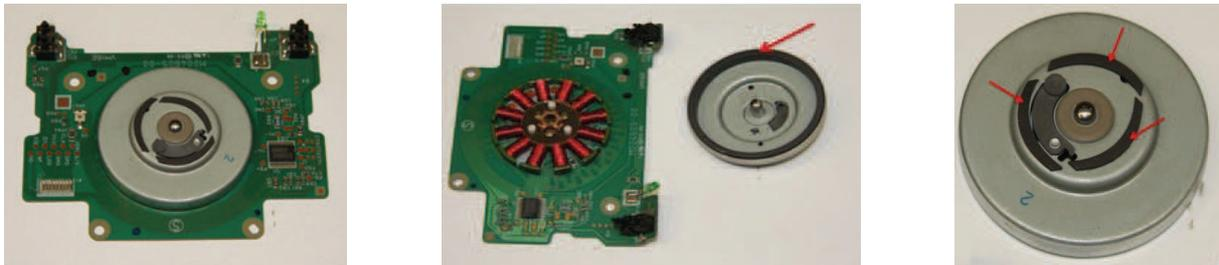
**Abb. 2.2.1:** Diskettenlaufwerk (Pfeile kennzeichnen Magnete)
