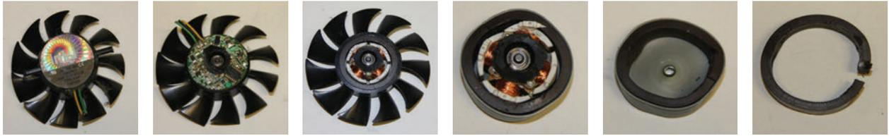
**Abb. 2.2.7:** Einzelschritte beim Auseinanderbau eines CPU-Lüfters bis zum kunststoffgebundenen Magneten
