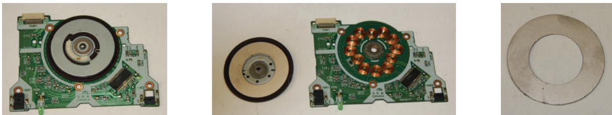
**Abb. 2.2.2:** Motor zum Drehen einer Diskette in Laptops
