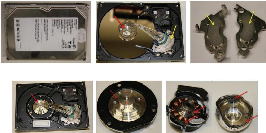
**Abb. 2.2.5:** Schritte des Zerlegens einer Festplatte in Magnete und Motor
