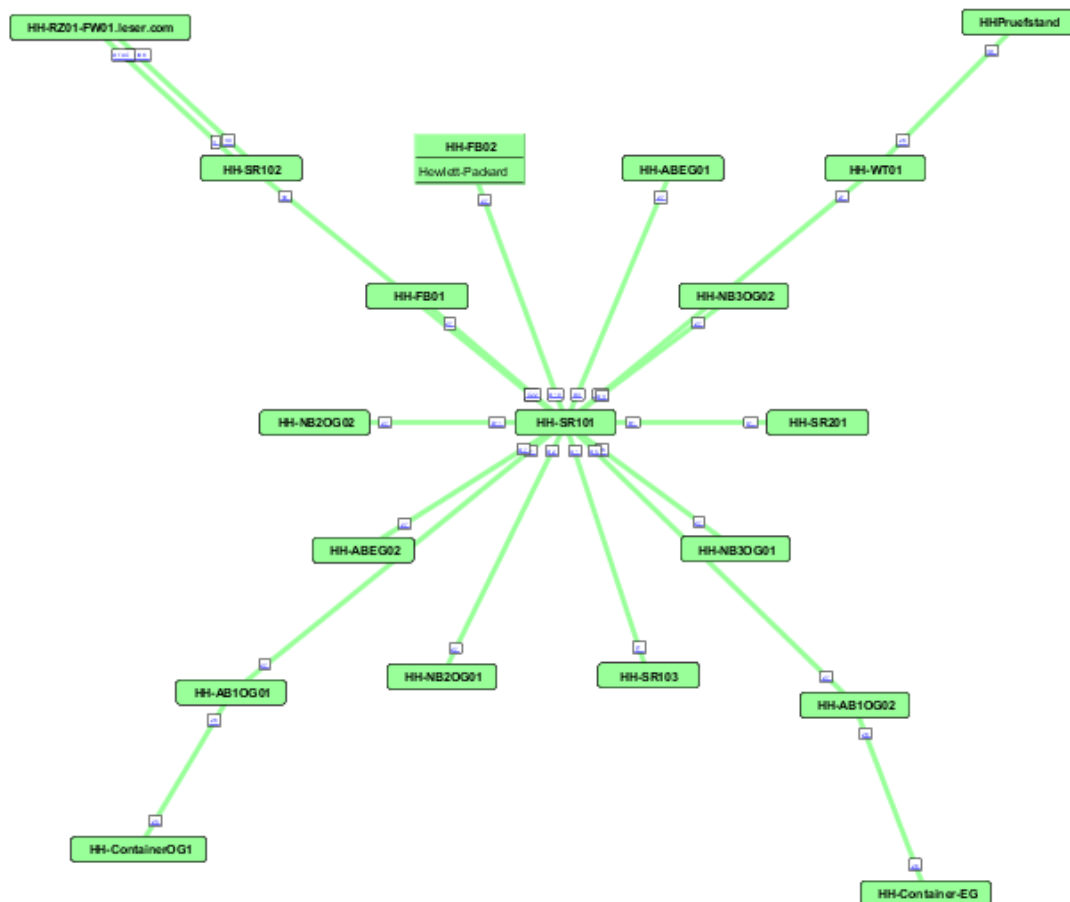
Abbildung 4-5: automatisch generierte Topologie des Standortes Hamburg
