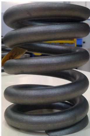
Abbildung 4.11: Kleine zylindrische Schraubenfeder
