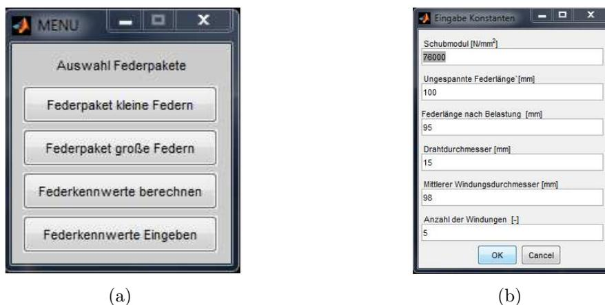
Abbildung 5.2: Auswahl der Federpakete (a) und Federberechnung (b)
