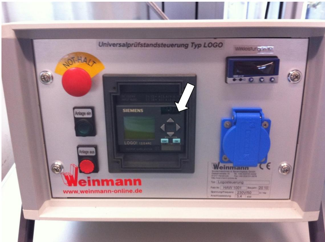
Abbildung 2: Vorderseite LOGO!-Modul mit Siemens-LOGO!-Steuerung
