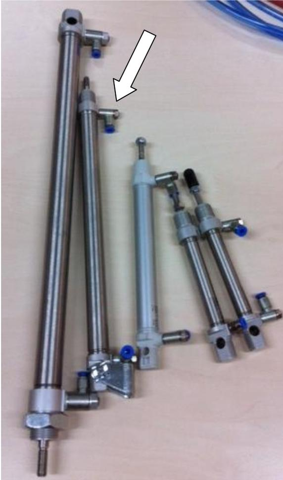
Abbildung 7: Pneumatische Aktoren mit Hub-Kolben
