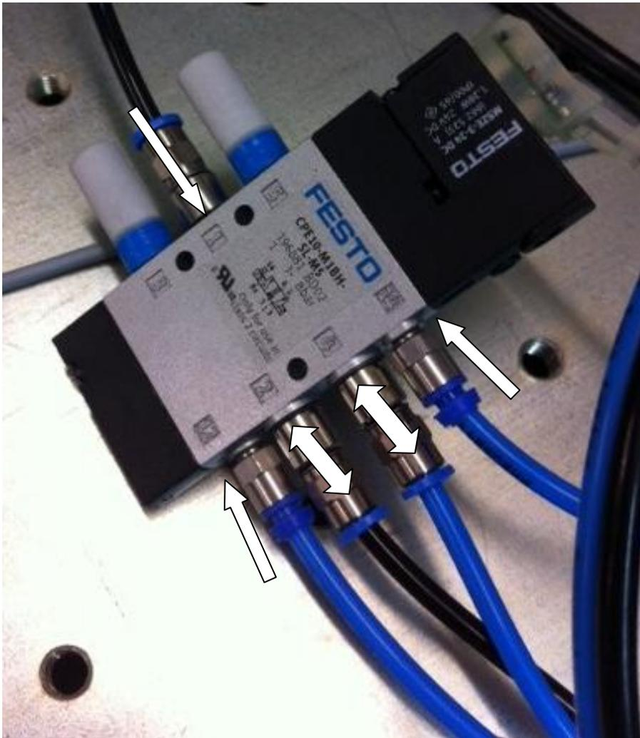
Abbildung 5: Elektrisches Universal-Magnetventil CPE10-M1BH-5L-M5
