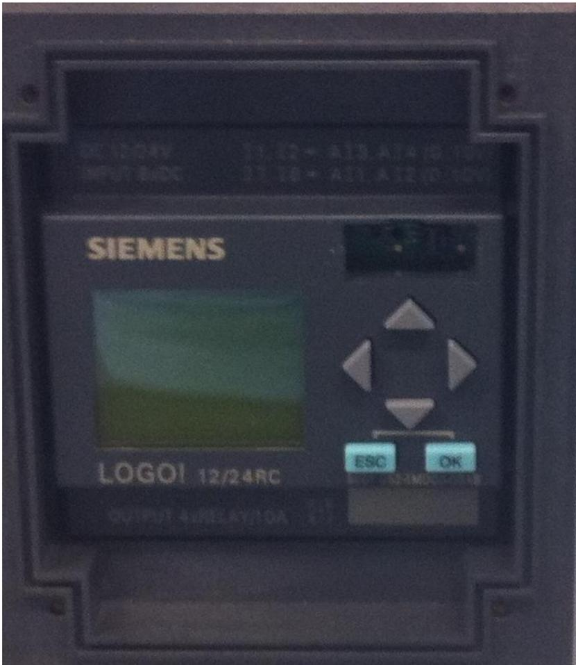
Abbildung 36: Vorderseite der LOGO!-Steuerung mit Vier-Cursortasten
