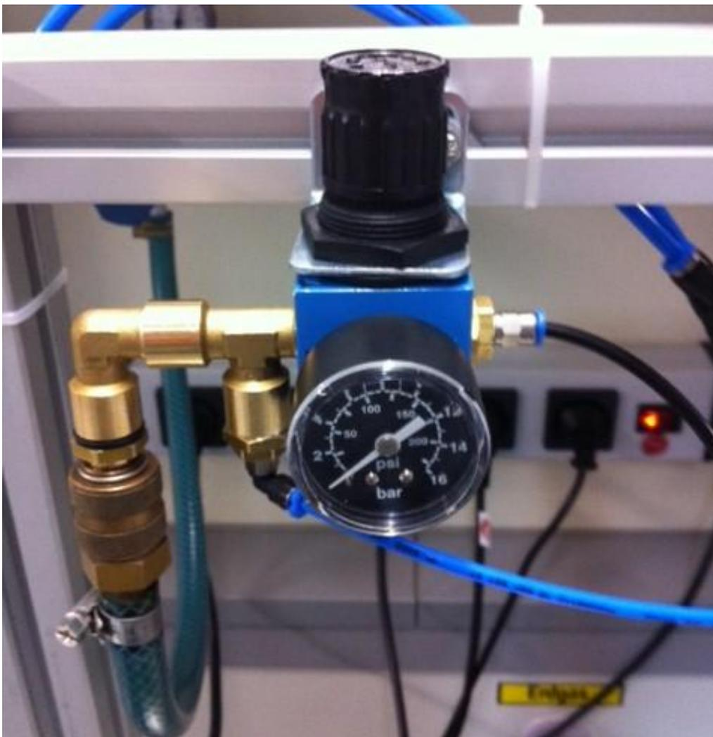
Abbildung 6: Druckluftventil zur Einstellung des Luftdrucks und Entnahme der Hilfsdruckluft
