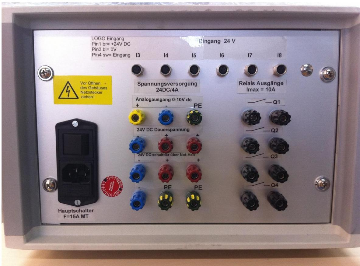
Abbildung 3: Rückseite LOGO!-Modul mit Siemens-LOGO!-Steuerung
