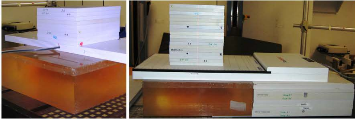
Abbildung 4.14: Beispiel Messaufbau Tiefendosismessung: links CC04 in 10 cm Tiefe, rechts MapCHECK in 20 cm Tiefe.
