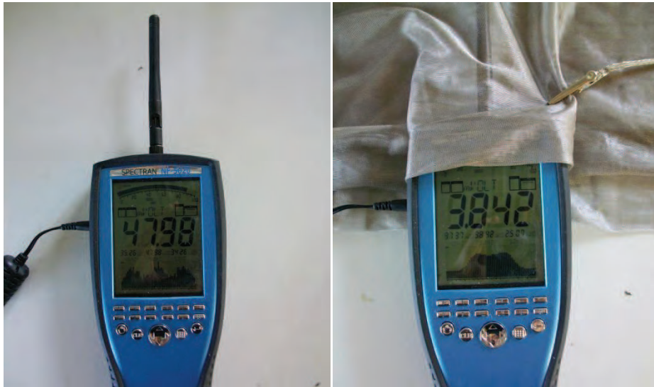
Abbildung 4-6: Messung der in der externen Antenne induzierten Spannung mit und ohne Aaronia-Shield®
