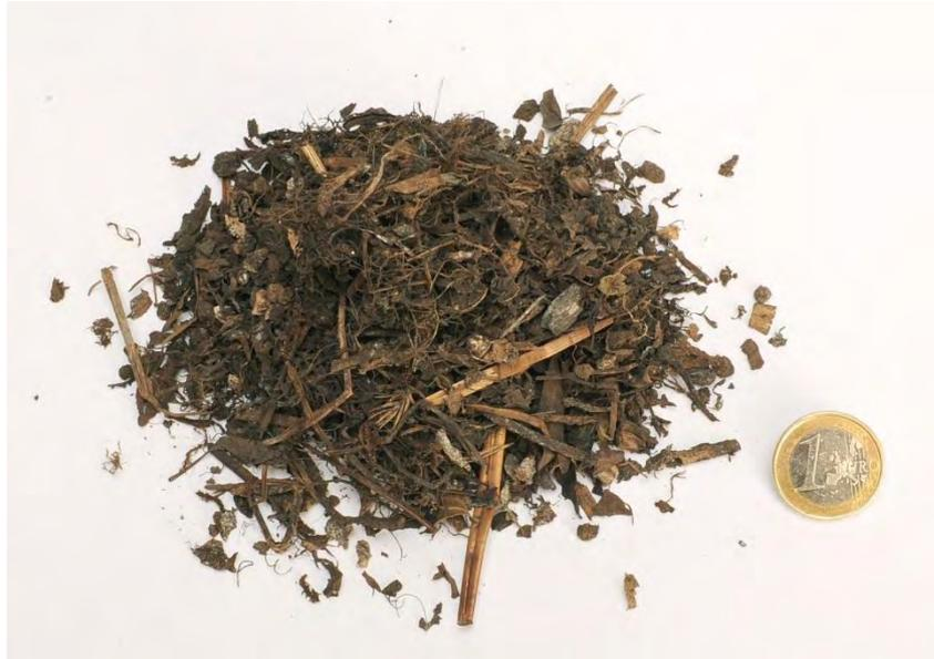
**Abbildung 36: Siebfraktion mittlerer Korngröße**
