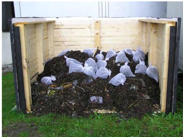
**Abbildung 17: Probenplatzierung im Komposter**
