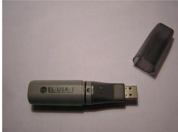
**Abbildung 20: Datenlogger zur Temperaturmessung**
