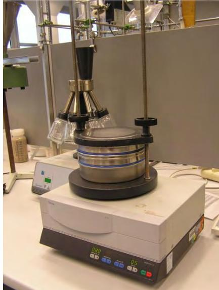
**Abbildung 34: Siebmaschine AS 200 control "g"**
