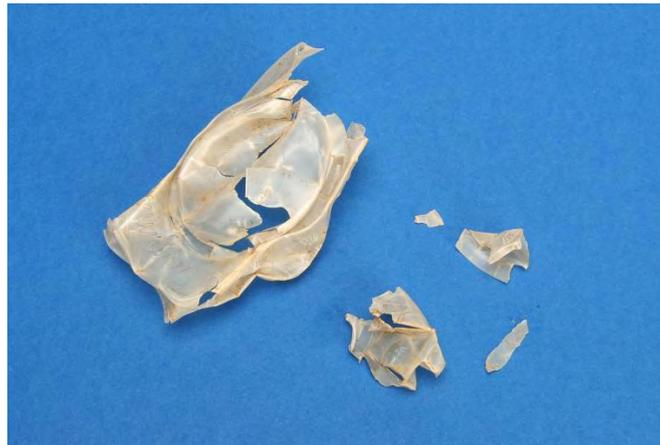
**Abbildung 47: Konventioneller "To-Go" Deckel nach 12wöchiger Kompostierung**
