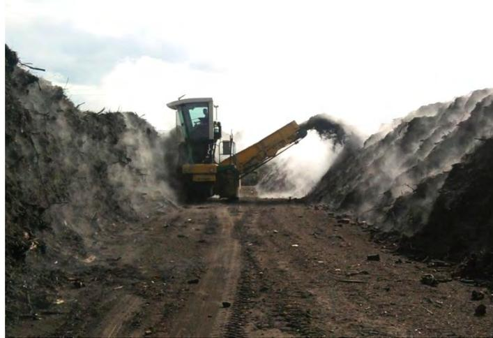
**Abbildung 31: Wende-und Belüftungsmaschine K+E**
