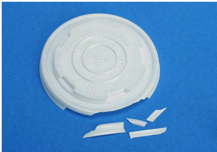
**Abbildung 45: "To-Go"-Becher-Deckel nach 12wöchiger Eigenkompostierung**
