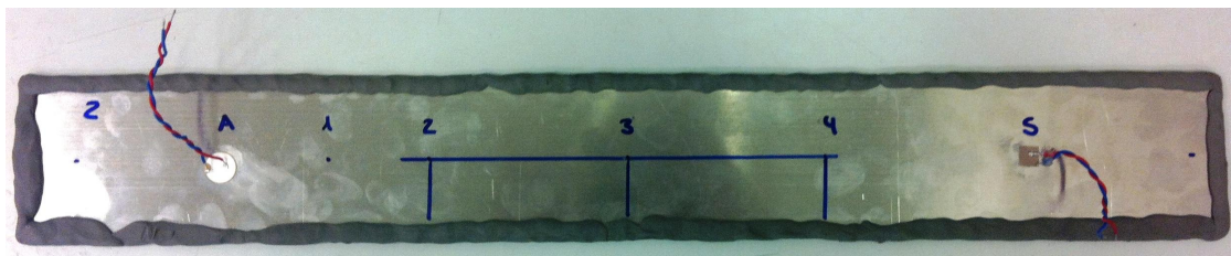
Abbildung 20: Aluminiumprobe mit Piezo-Aktor und -Sensor, sowie den Markierungen zum Einbringen der Schädigungen
