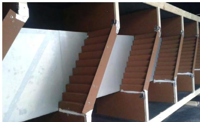
**Abbildung 4-12:** Versuchsmodell mit verschlossenem Treppenauge
