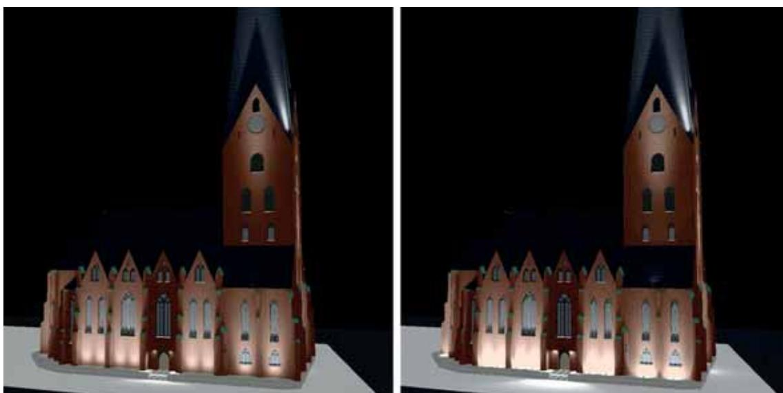
*Abbildung 50: Direkter Vergleich der berechneten Lichtwirkung Ansicht Nord - LED links und konventionell rechts (eigene Abbildung)*
