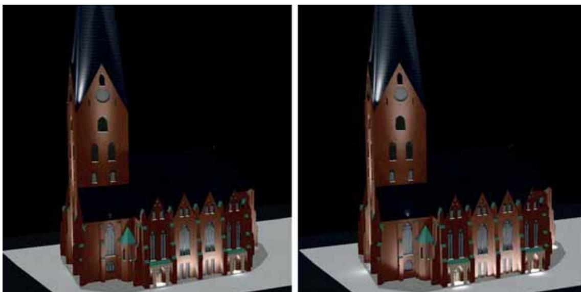
*Abbildung 51: Direkter Vergleich der berechneten Lichtwirkung Ansicht Süd - LED links und konventionell rechts (eigene Abbildung)*
