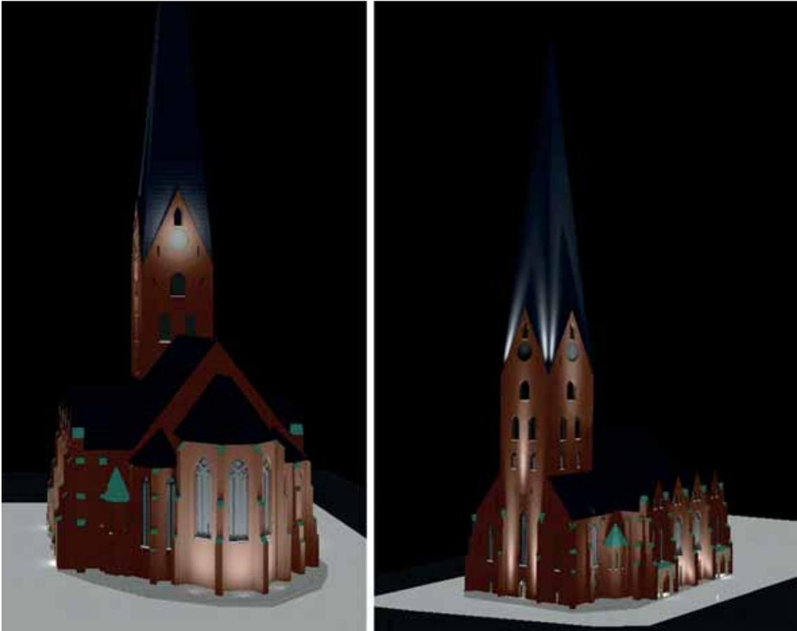
Abbildung 28: Lichtszene aus DIALux mit LED Beleuchtung Ansicht Ost (links) und Ansicht Südwest (rechts) (eigene Abbildung)
