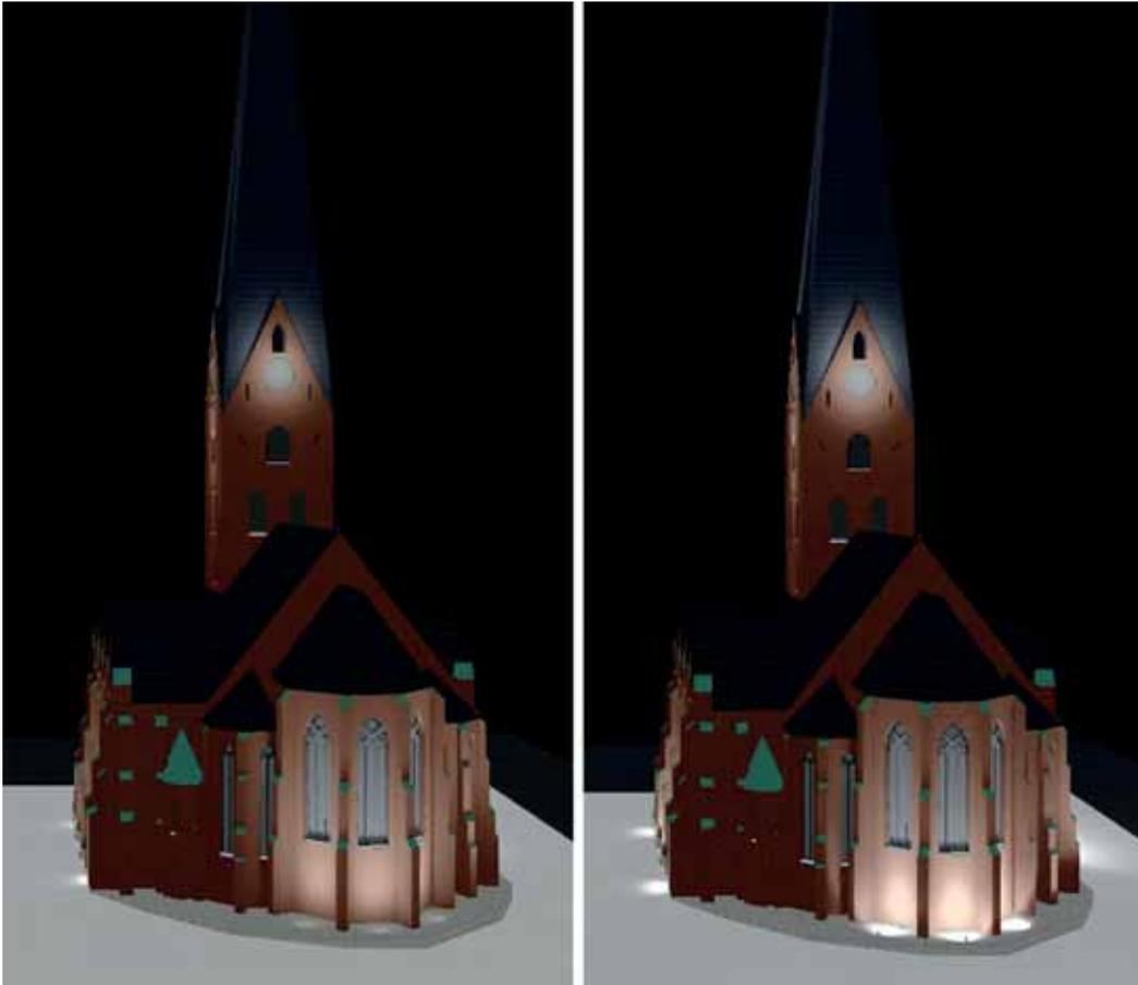
*Abbildung 52: Direkter Vergleich der berechneten Lichtwirkung Ansicht Ost - LED links und konventionell rechts (eigene Abbildung)*
