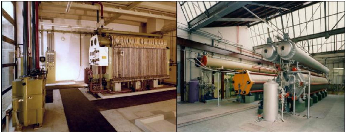
Abbildung 14: Alkalische Elektrolyseure. Links: atmosphärischer Elektrolyseur (BAMAG-Bauart) mit Wasserstoffleistung von 300 Nm 3 /h; rechts: Druckelektrolyseur (Lurgi-Bauart) mit Wasserstoffleistung von 760 Nm 3 /h. Quelle: [43].
