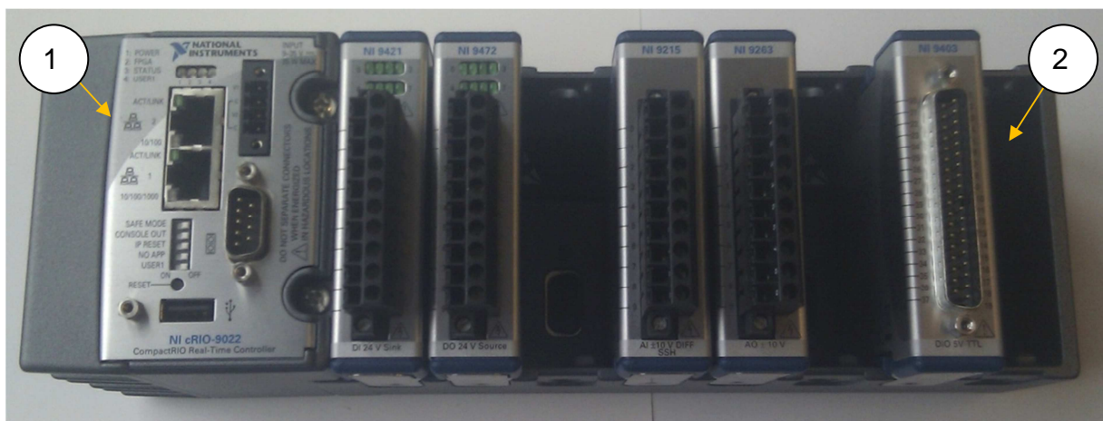
Abb. 8 Die für diese Arbeit verwendete Hardware von NI. Zu sehen sind der Controller (1), das Chassis (2) und die Module.
