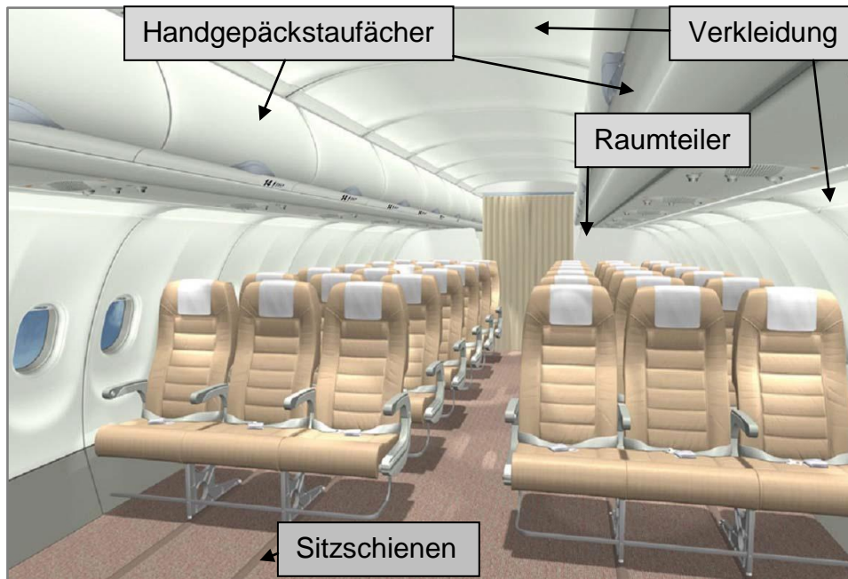
Abb. 2-6: typischer Kabinenaufbau heutiger Kurzstreckenflugzeuge [6]
