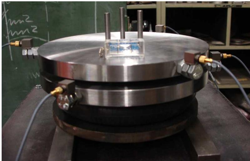
**Abbildung 7.5: Ausrichtung und Zentrierung der Einzelteile und Beschleunigungsaufnehmer**
