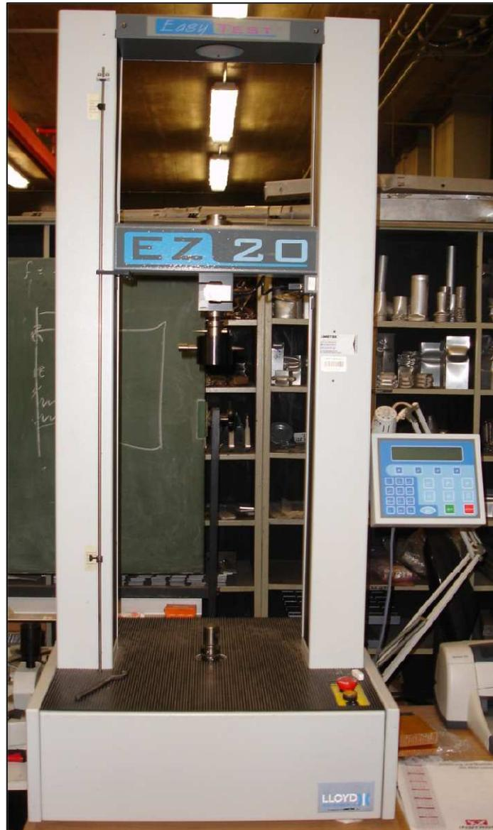
Abbildung 5.1: Zug/Druck-Prüfmaschine EZ 20 von EasyTest
