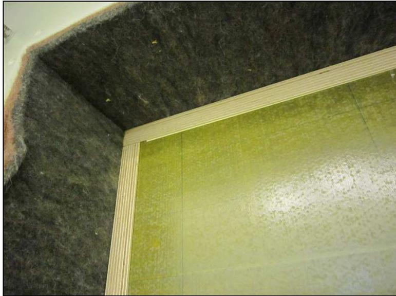
Abbildung 6.4: Sandwich-Deckplatte mit Abstandsleiste im Transmissionsfenster
