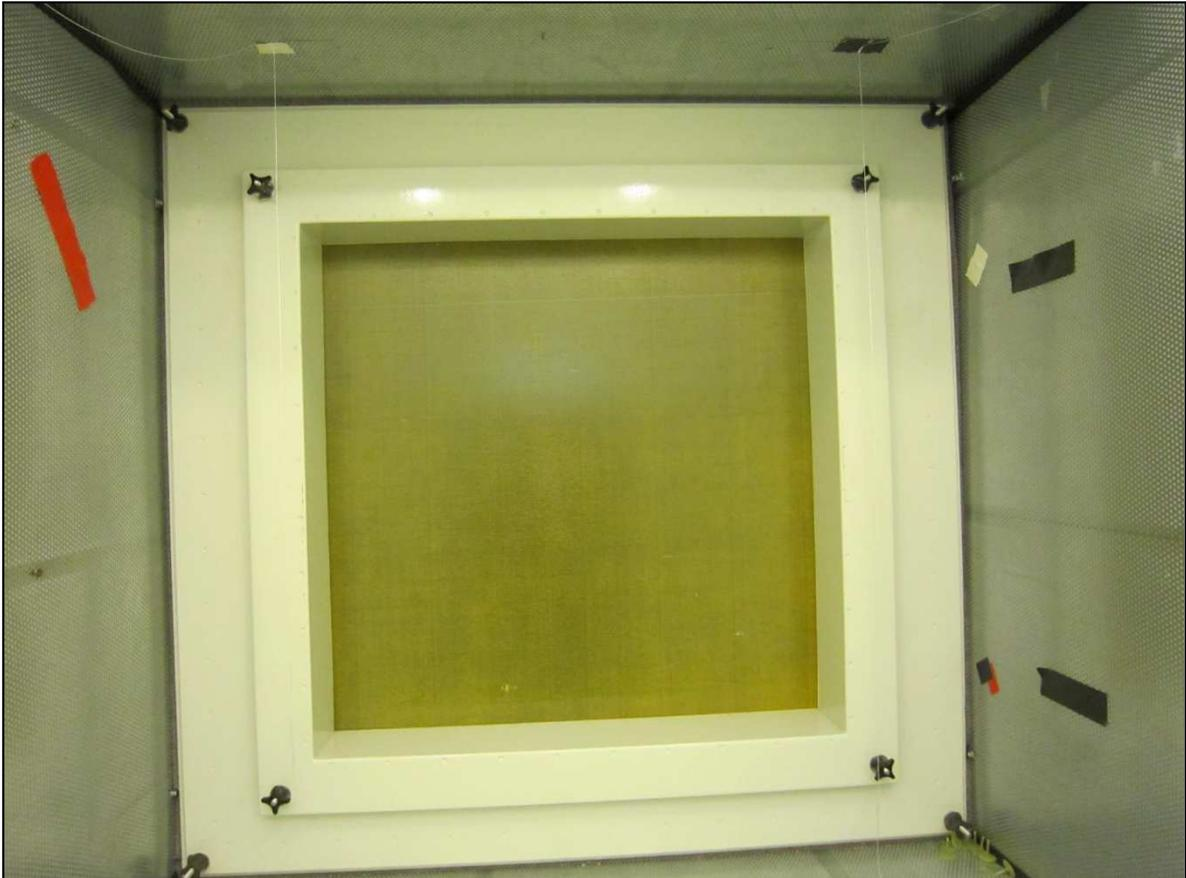
Abbildung 6.5: Fensterrahmen des Transmissionsprüfstands
