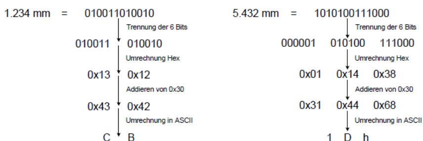
Abbildung 7.5: Kodierung der übertragenden Entfernungswerte mit 2 Byte oder 3 Byte [28].
