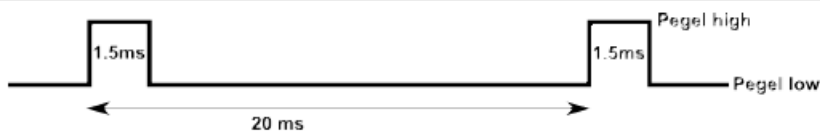
Abbildung 5.6: Auswirkung der Impulslänge des PWM-Signals zur Ansteuerung der Motoren auf Antrieb und Lenkung [1].
