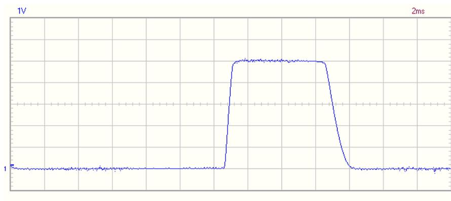
Bild 3.6.: Spannungsverlauf nach Optokoppler
