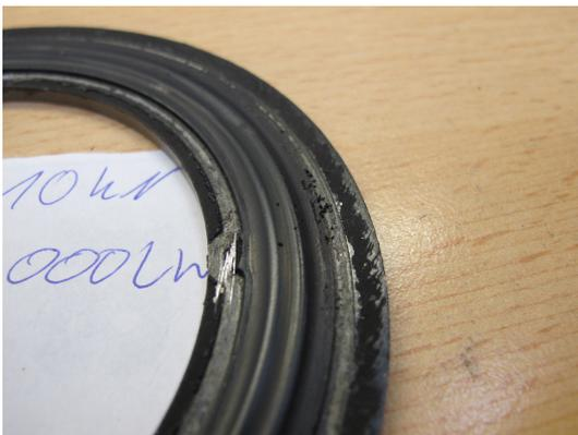
Abbildung C.11.: 525V-05 nach 3000 Lastwechsel bei 10kN Vorlast
