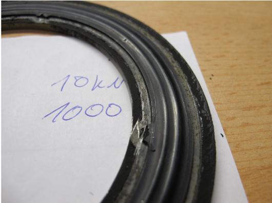
Abbildung C.9.: 525V-05 nach 1000 Lastwechsel bei 10kN Vorlast
