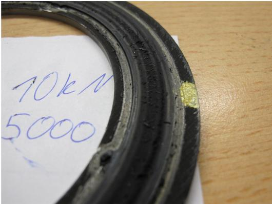
Abbildung C.13.: 525V-05 nach 5000 Lastwechsel bei 10kN Vorlast
