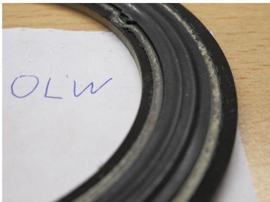
Abbildung C.1.: 525V-04 nach 0 Lastwechsel bei  $20kN$  Vorlast
