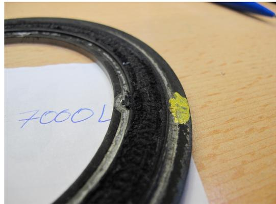
Abbildung C.8.: 525V-04 nach 7000 Lastwechsel bei  $20kN$  Vorlast
