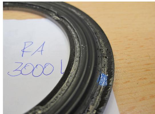
Abbildung C.19.: 544V-01 nach 3000 Lastwechsel bei 20kN Vorlast
