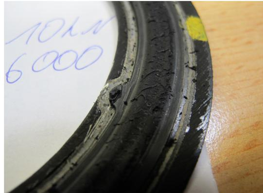
Abbildung C.14.: 525V-05 nach 6000 Lastwechsel bei 10kN Vorlast
