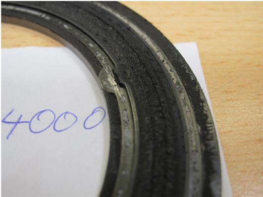
Abbildung C.5.: 525V-04 nach 4000 Lastwechsel bei  $20kN$  Vorlast
