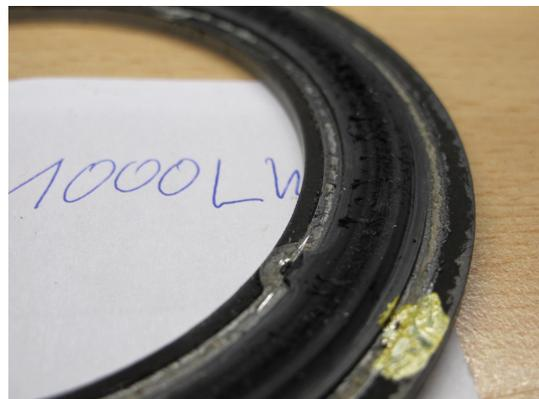
Abbildung C.2.: 525V-04 nach 1000 Lastwechsel bei  $20kN$  Vorlast
