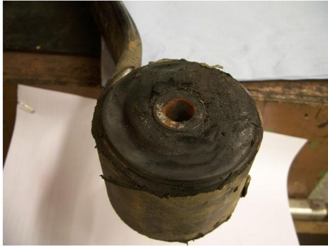
Abbildung 1.2.: Abrieb an der Oberfläche eines Axialanschlags
