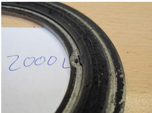
Abbildung C.3.: 525V-04 nach 2000 Lastwechsel bei  $20kN$  Vorlast
