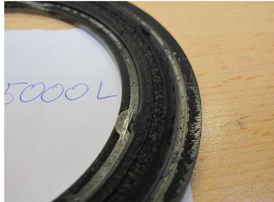
Abbildung C.6.: 525V-04 nach 5000 Lastwechsel bei  $20kN$  Vorlast
