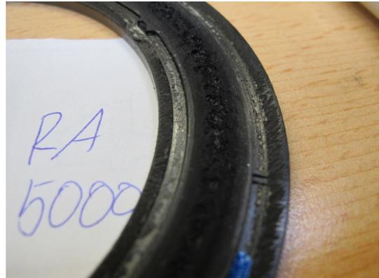
Abbildung C.21.: 544V-01 nach 5000 Lastwechsel bei 20kN Vorlast
