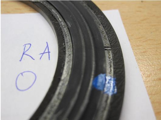
Abbildung C.16.: 544V-01 nach 0 Lastwechsel bei 20kN Vorlast
