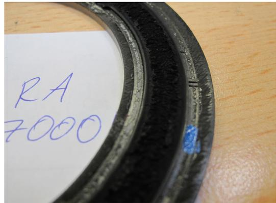
Abbildung C.23.: 544V-01 nach 7000 Lastwechsel bei 20kN Vorlast
