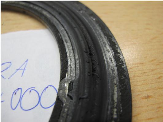
Abbildung C.20.: 544V-01 nach 4000 Lastwechsel bei 20kN Vorlast
