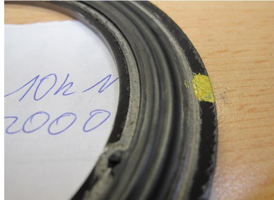
Abbildung C.10.: 525V-05 nach 2000 Lastwechsel bei 10kN Vorlast
