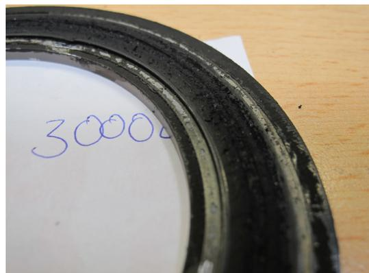
Abbildung C.4.: 525V-04 nach 3000 Lastwechsel bei  $20kN$  Vorlast
