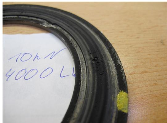
Abbildung C.12.: 525V-05 nach 4000 Lastwechsel bei 10kN Vorlast
