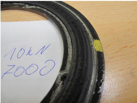
Abbildung C.15.: 525V-05 nach 7000 Lastwechsel bei 10kN Vorlast
