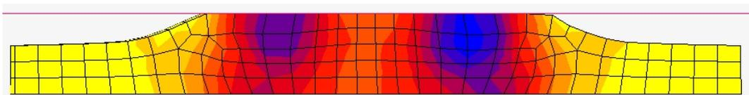
Abbildung 5.6.: Querschnitt des FE-Modells nach dem Aufbringen der Vorlast
