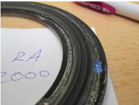
Abbildung C.18.: 544V-01 nach 2000 Lastwechsel bei 20kN Vorlast
