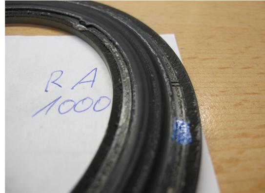
Abbildung C.17.: 544V-01 nach 1000 Lastwechsel bei 20kN Vorlast
