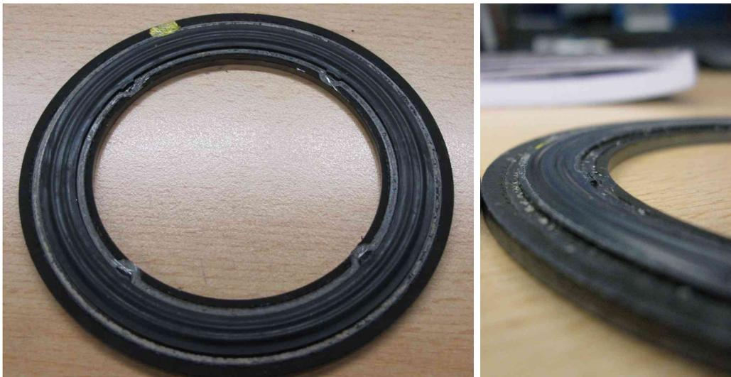
Abbildung 4.4.: Draufsicht und seitliche Ansicht des Probekörpers S810078 im unverschlissenen Zustand
