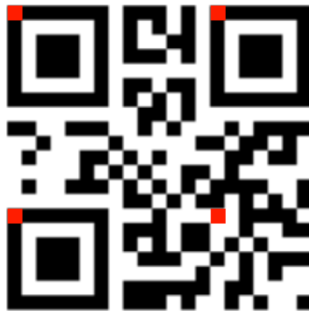
Abbildung 4.18 Punkte zur Bestimmung des Referenzgitters
