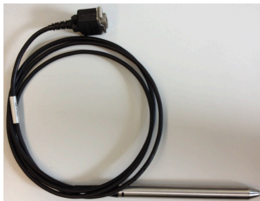
Abbildung 3.3 Lesestift P51 von Datalogic mit D-Sub Stecker
