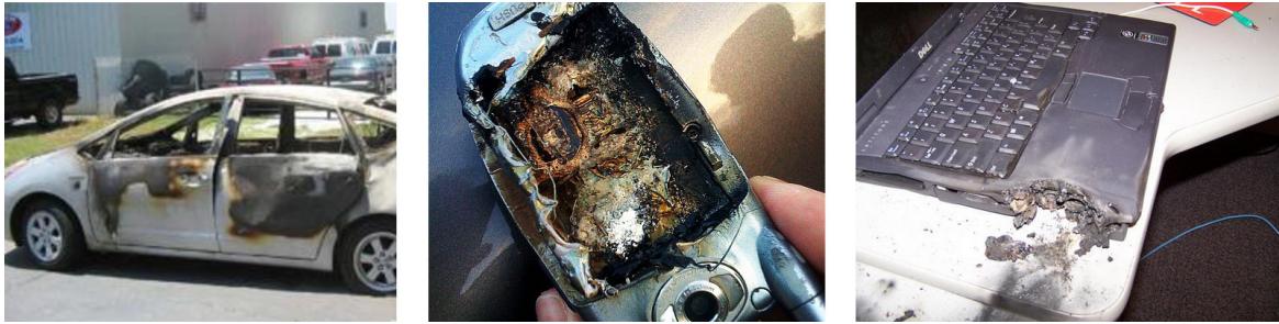
Abbildung 1.6: Beispiele für Li-Ionen-Brände [19] [38] [37]
