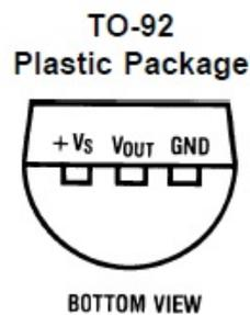
Abbildung 3.5: Bodenansicht LM35 Temperatursensor im TO-92 Gehäuse (Quelle [2])
