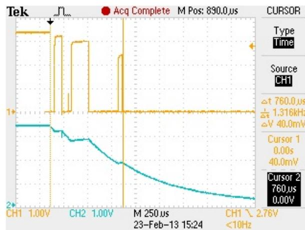
Abbildung 3.14: Gemessene Spannungen innerhalb der Entprellschaltung
