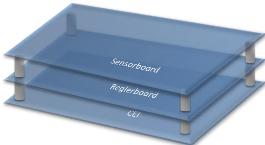
Abbildung 2.10: Prinzipskizze des Kartenstapels der im Umrichter integrierten Mess- und Regeleinrichtung |
