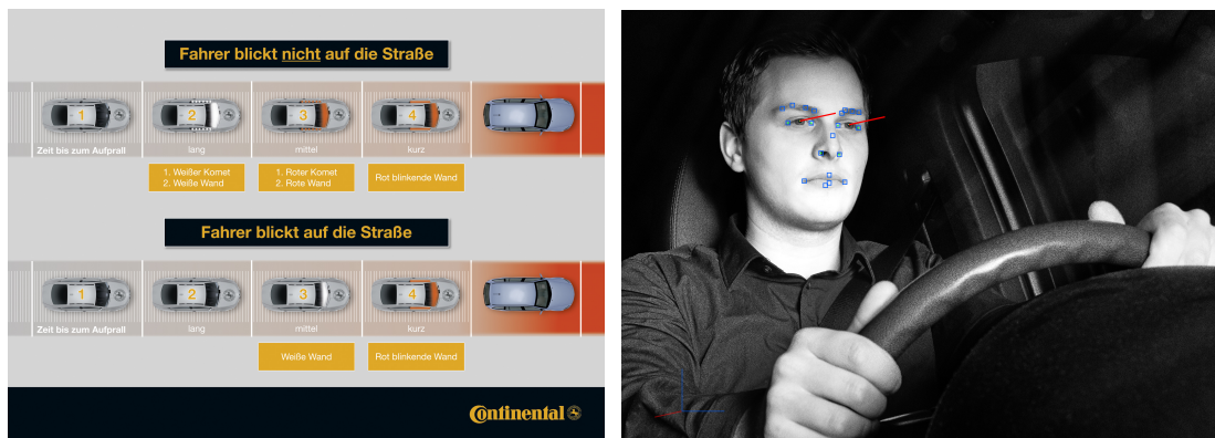
a: Warnstufen des LED-Warnsystems mit und ohne Ablenkung (© Continental 7 ) b: Aufnahme mit Infrarotkamera zur Erkennung der Blickrichtung des Fahrers (© Continental 8 )
