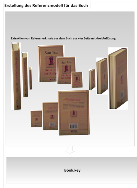
Abbildung 5.4.: Erstellung des Referenzmodells „Buch“ aus vier Perspektiven mit jeweils drei unterschiedlichen Auflösungen
