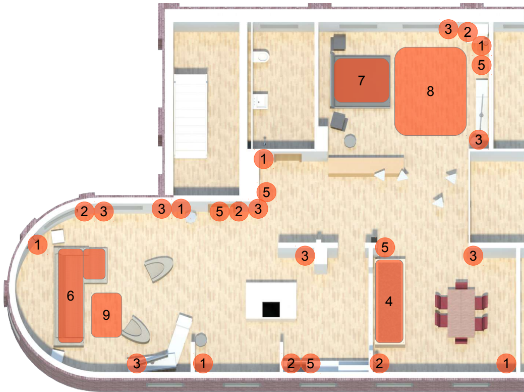
Abbildung 3.1: Laborsensorik im Wohnbereich des Living Place Hamburg: [1] Positions-erkennung [2] Kameras [3] Kabelloses Sensornetzwerk [4] Multitouch-Tresen SiBar [5] Mikrofone [6] Couchsensorik [7] Intelligentes Bett [8] Sturzerkennung [9] Multitouch Tisch
