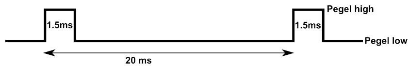
Abbildung 4.17: PWM zur Ansteuerung der Motoren für Antrieb und Lenkung: Ein High-Pegel mit einer Impulslänge von 1ms-2ms (Hier: 1,5ms) wird alle 20ms wiederholt.
