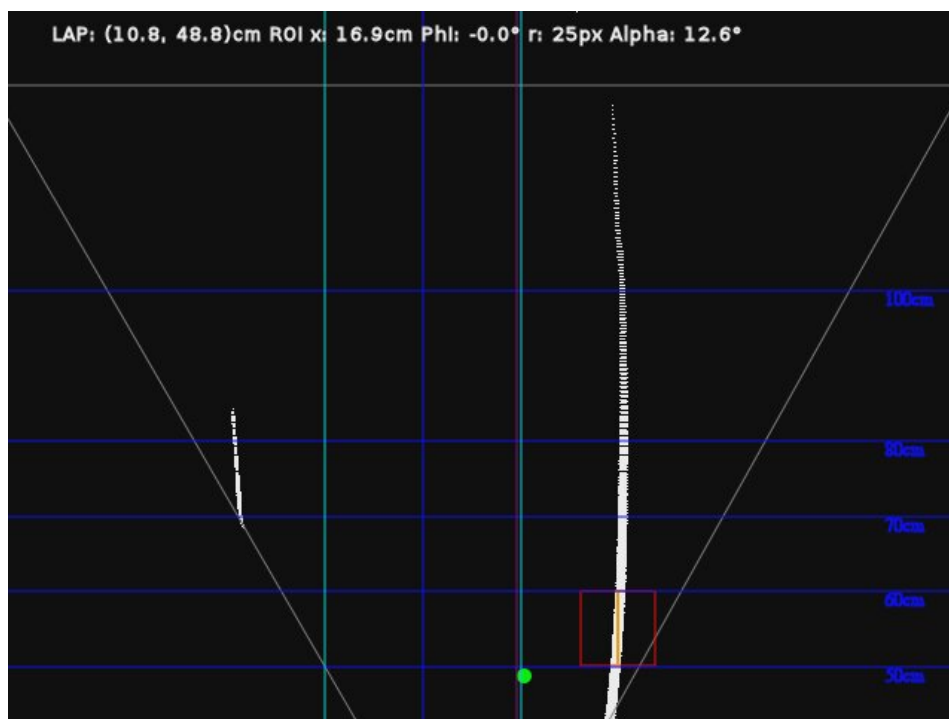
Abbildung 5.13: StraÙe nach der Projektiven-Transformation mit den Ergebnissen der Hough-Transformation (orange) und Spurführung. Es werden der LAP (grün), die ROI (rot), das Fahrzeugkoordinatensystem (blau), der Sollabstand d (violett) sowie die Kanten des Fahrzeugs (türkis) dargestellt.
