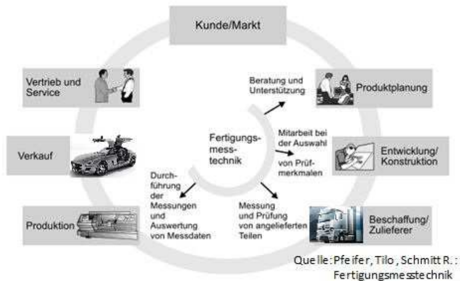
Abbildung 2.1: Fertigungsmesstechnik im Qualitätskreis
