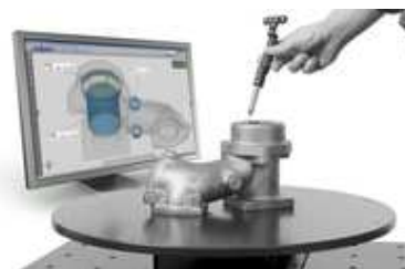
Abbildung 4.11: ATOS in Kombination mit GOM Taster (GOM mbH)
