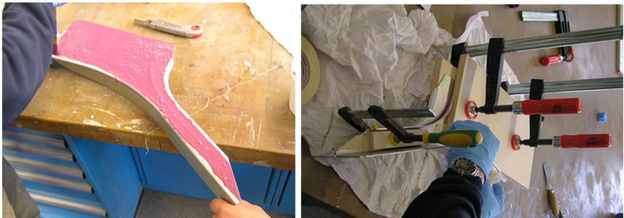
Abbildung 29: Durchführung der Testklebung mit Hysol EA 9309.3 NA
