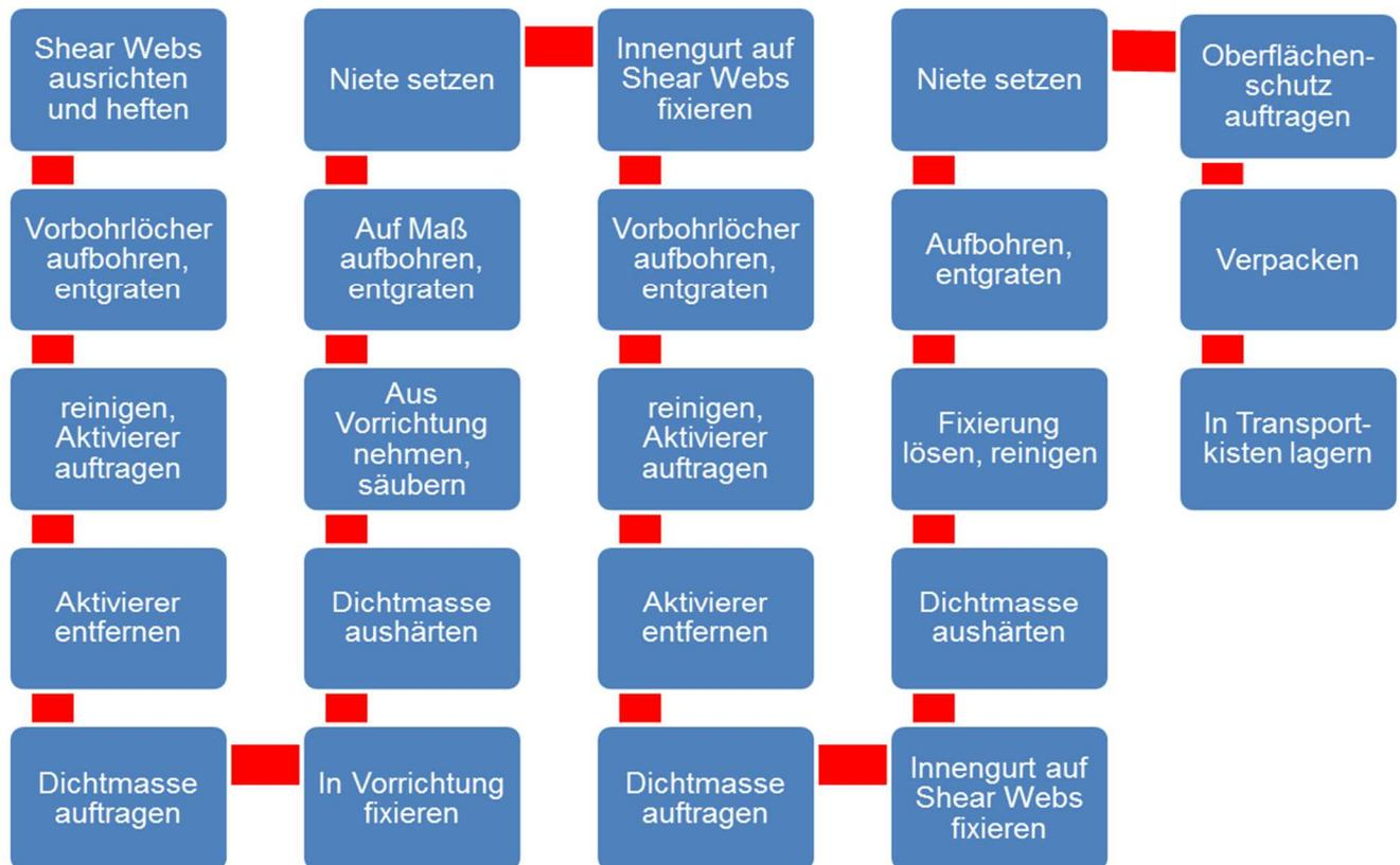
Abb.20: Flussdiagramm des Fertigungsprozesses der Tension Struts
