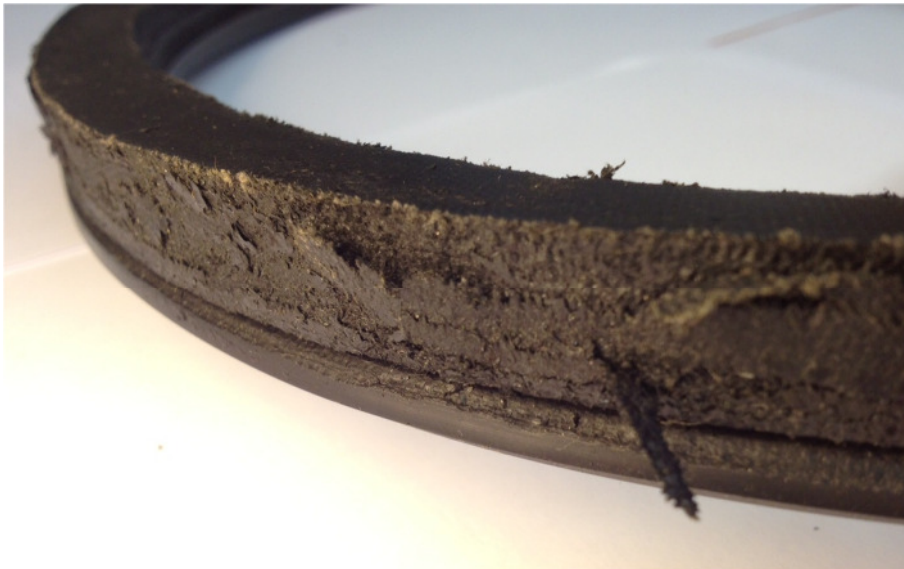
Abbildung 8 - Schadensbild Nutring (Eigene Darstellung)
