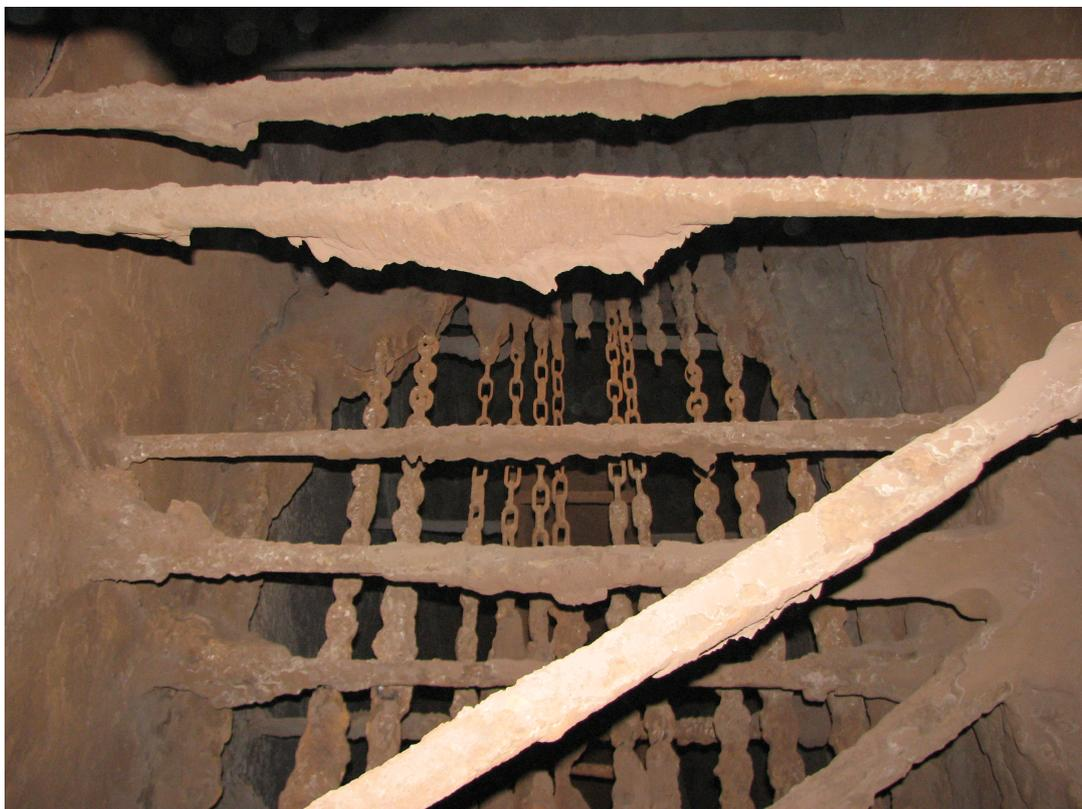
**Abbildung 2.5:** Kettenvorhang mit deutlichen Anbackungen in der Mischkammer
