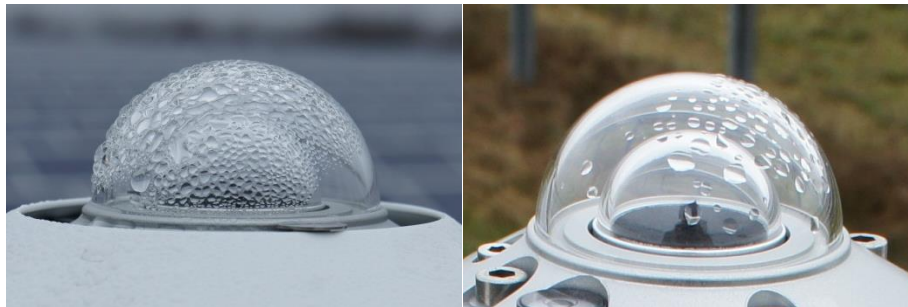
Abbildung 31: Trocknung der Glasdome
