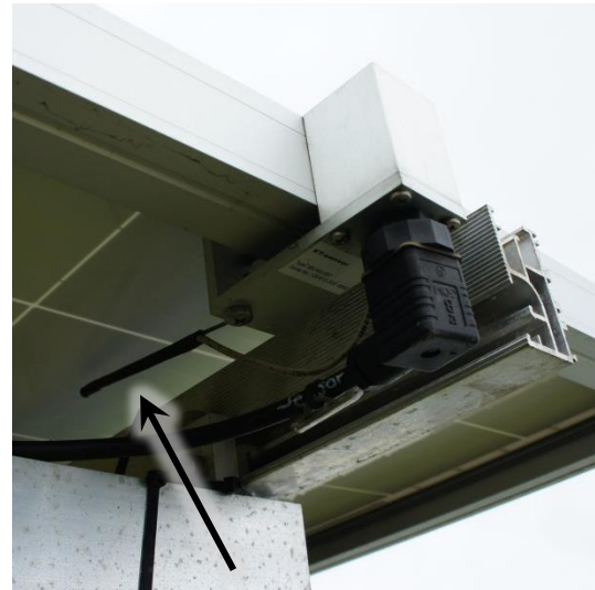
Abbildung 24: Temperaturfühler an ET Sensor
