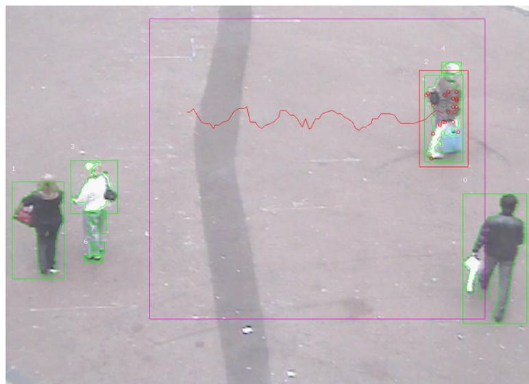
Abbildung 2.7.: Hand from above - Bildanalyse mit einfacher Bewegungserkennung
