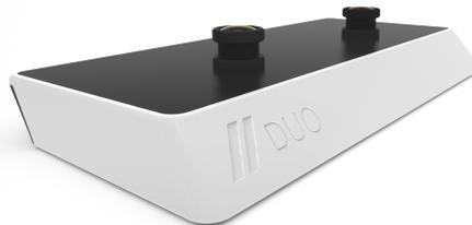
Abbildung 2.5.: Gerenderte Ansicht der NUI Group DUO mit den beiden PS3 Eyes auf der Oberseite
