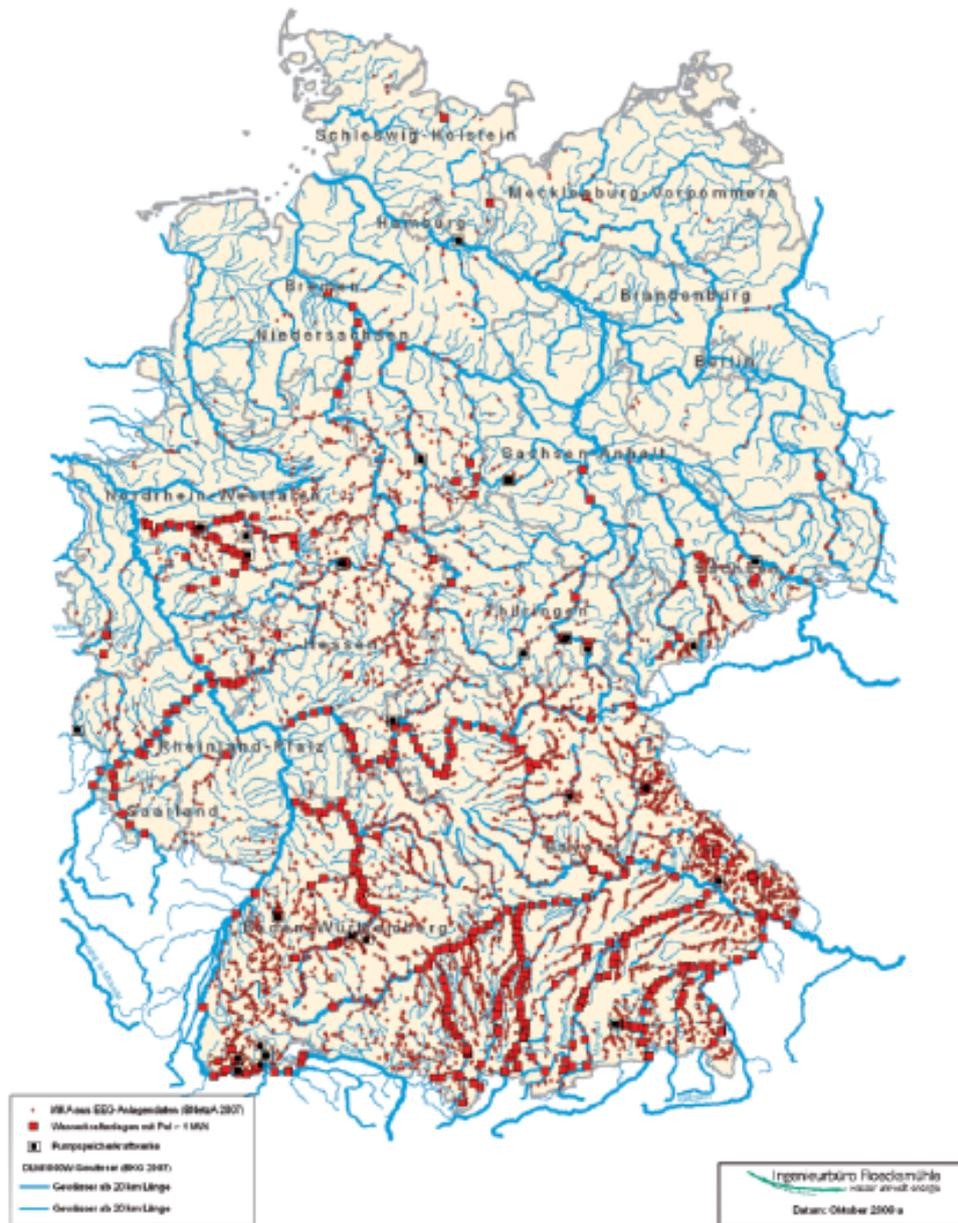
**Bild 1:** Bestand der genutzten Wasserkraftanlagen in Deutschland; berücksichtigt wurden Wasserkraftanlagen mit EEG-Vergütung [11], WKA mit  $P_{inst} \geq 1 \text{ MW}$  und Pumpspeicherkraftwerke (DLM1000W: Bundesamt für Kartographie und Geodäsie) <sup>1</sup>
