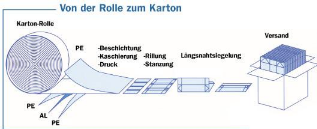
Abbildung 6.2: Schematische Darstellung der Herstellung von einem zugeschnittenen Karton; Quelle: www.getraenkekarton.de
