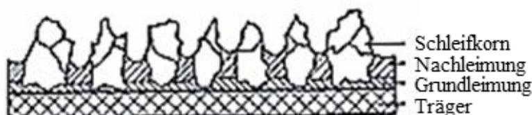
**Abbildung 1:** Schematischer Aufbau von Schleifmittel auf Unterlage [8]
