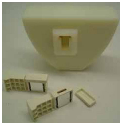
Abbildung 8. Bild der verwendeten OC-100 Küvetten und der Einführöffnung in das STX™-System.
