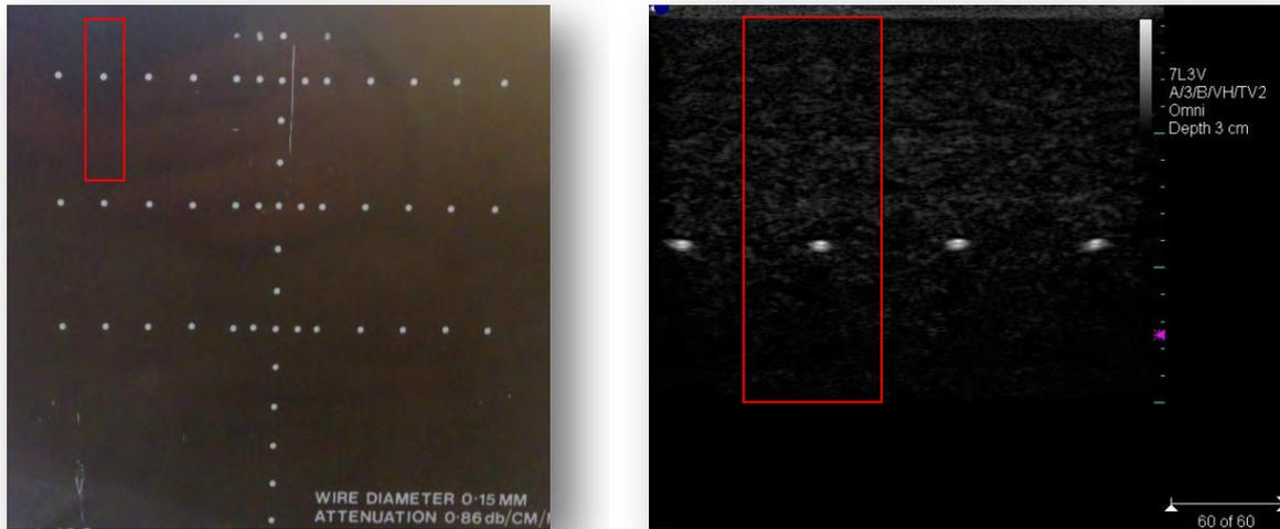
**Abbildung 3-7: Markierung des betrachteten Bereichs im Faden-Phantom (links) und Ultraschallbild (rechts)**
