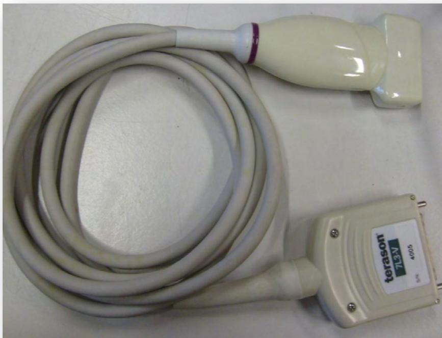
**Abbildung 3-2: Terason 7MHz LA-Ultraschallwandler**
