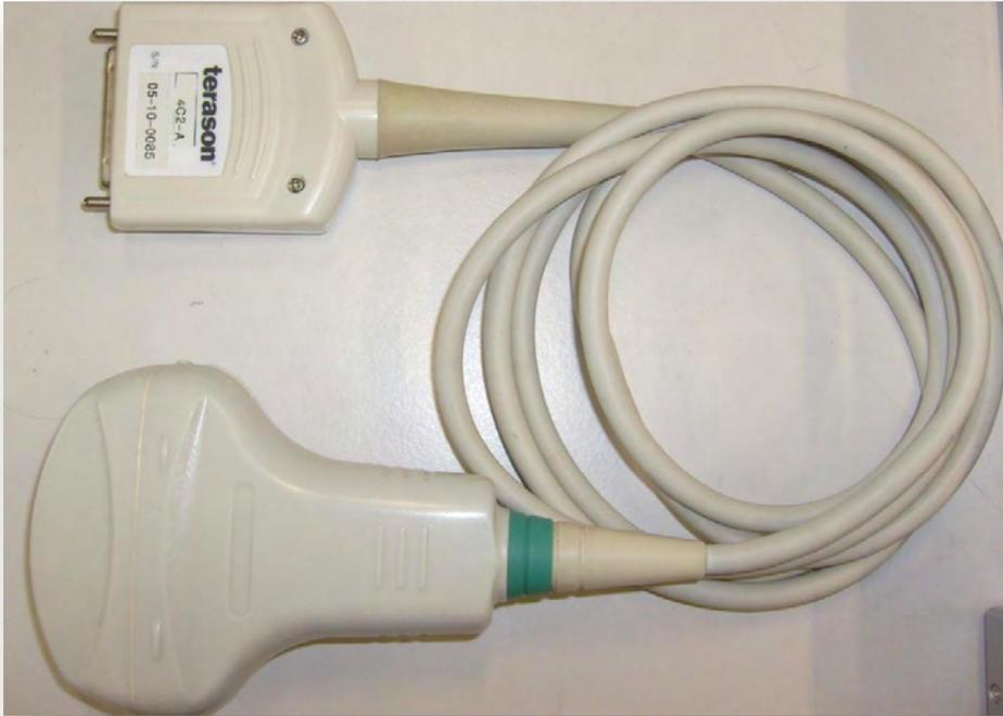
**Abbildung 3-3: Terason 4MHz CA-Ultraschallwandler**
