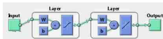
Abbildung 5.1: Aufbau eines Netzes zur Funktionsapproximation
