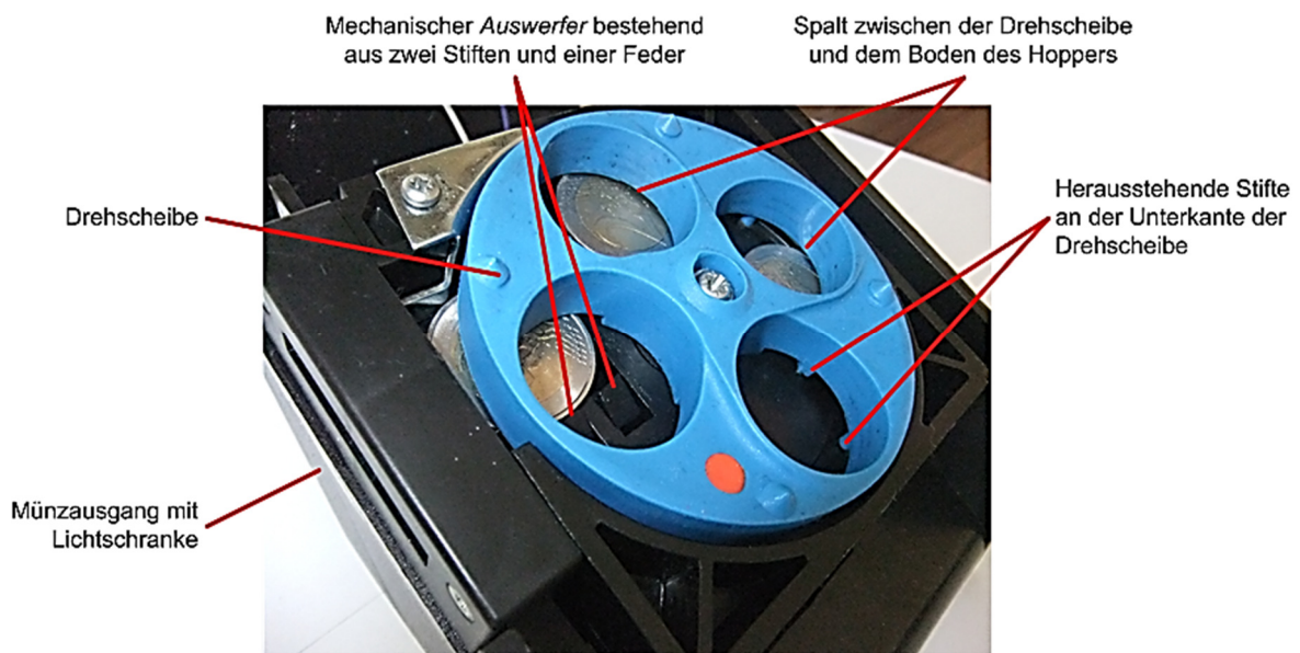
Bild 2.2: Beschreibung der Münzausgabe des Serial Compact Hoppers MK2
