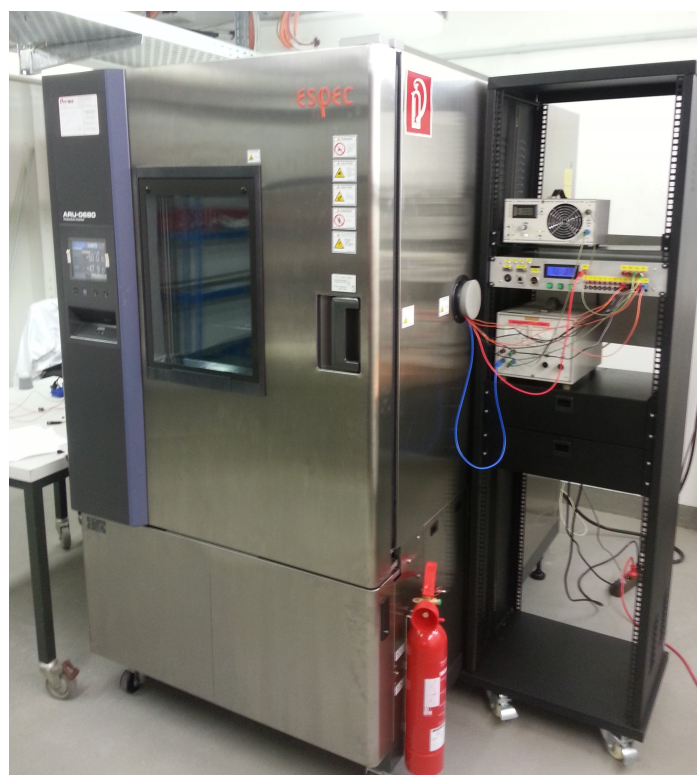
Abbildung 5.3.: Messaufbau Versuch mit 4 Zellen am Temperaturschrank
