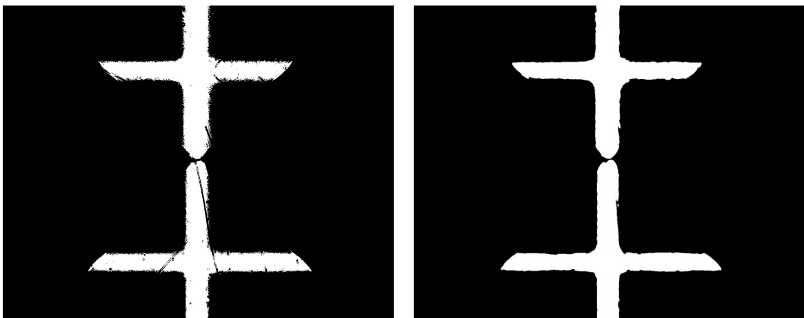
Abbildung 5-5: Binarisieren des Bildes ohne (l.) und mit angewendetem Gauß-Filter (r.)
