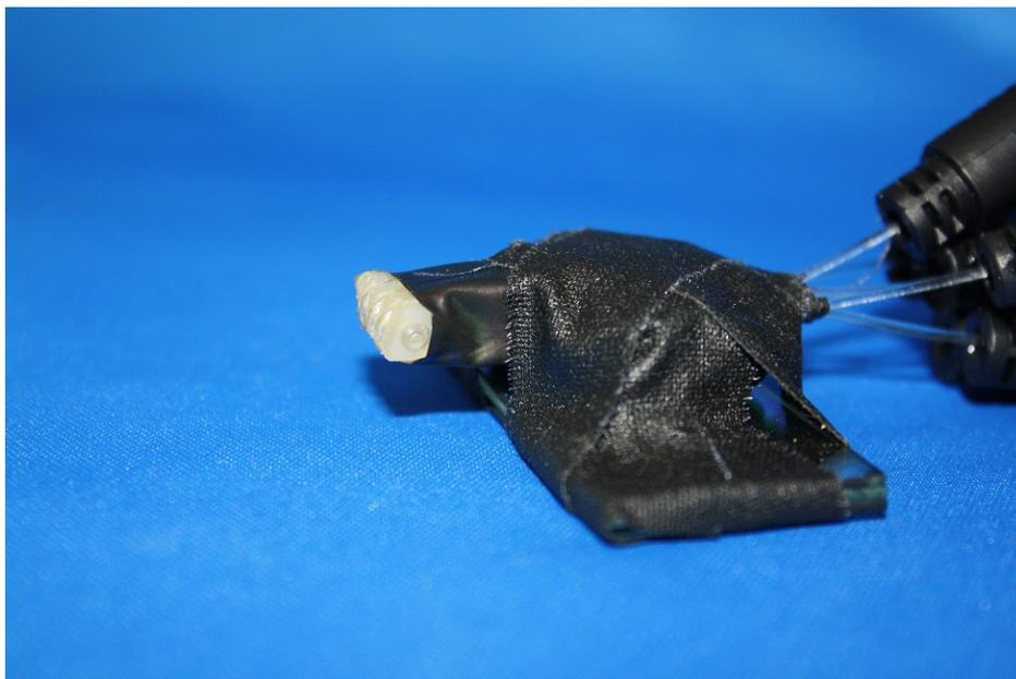
Abbildung 4.18.: Präparation und Fixierung von Lichtwellenleitern für den Lichtaustritt
