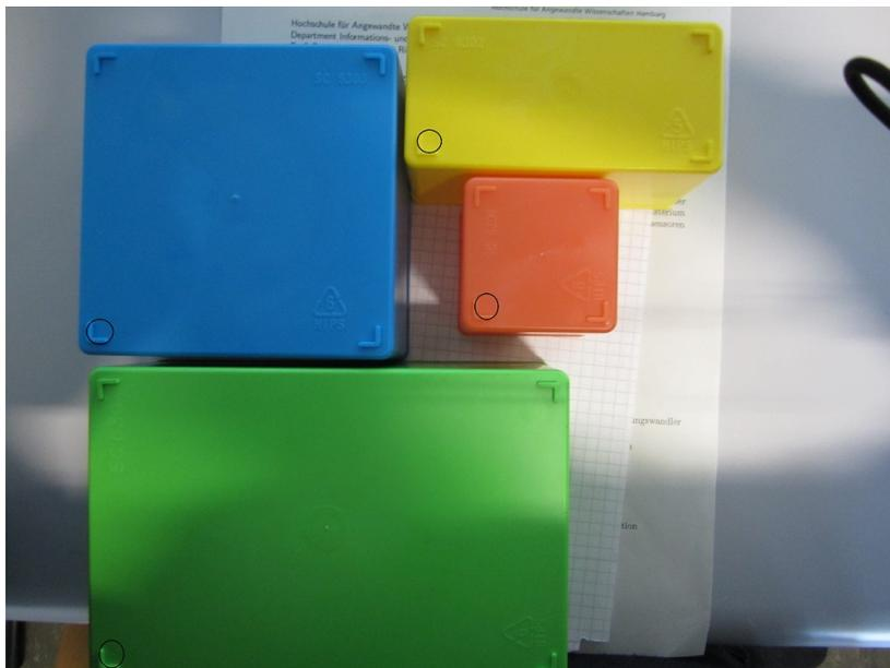
Abbildung 6.5.: Probefarben für Reflexionsmessungen. Die eingekreisten Stellen stellen die Messpunkte dar.
