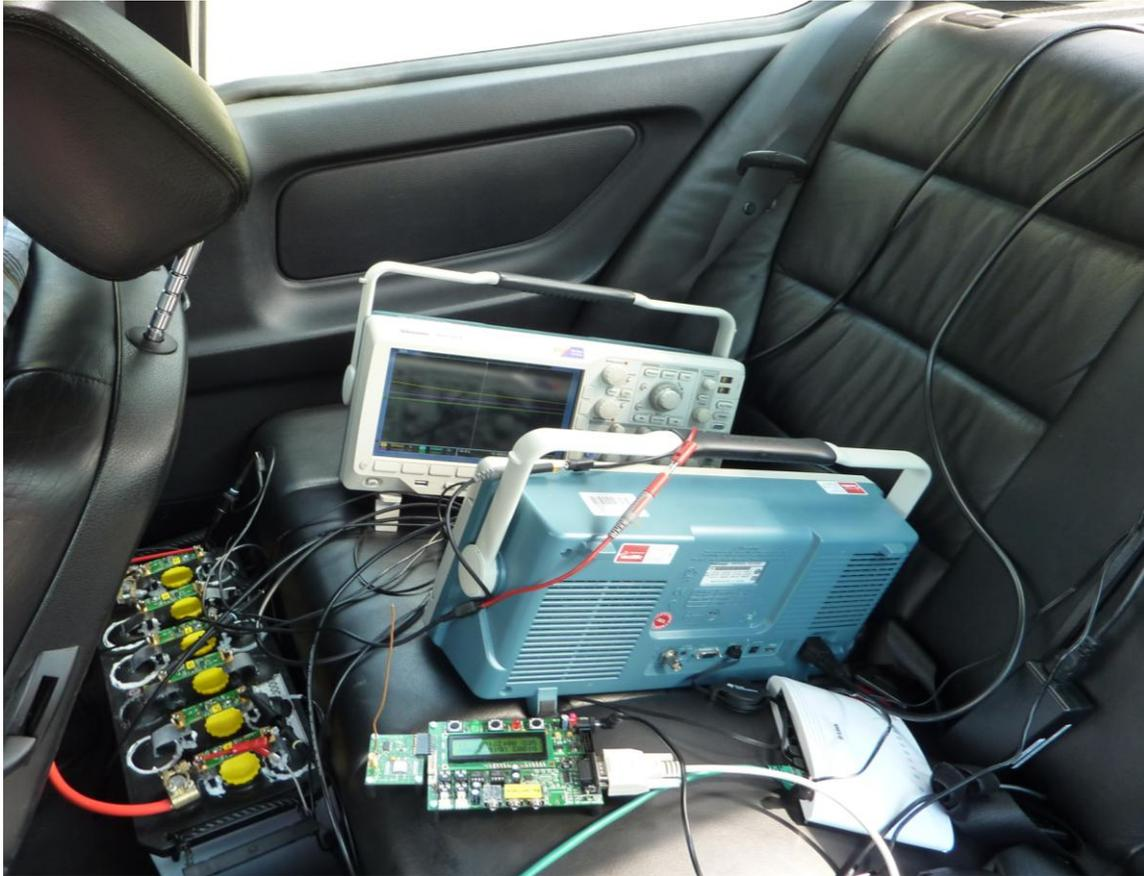
Abb. 6.11 Platzierungen der Messgeräte und der Erprobungsbatterie
