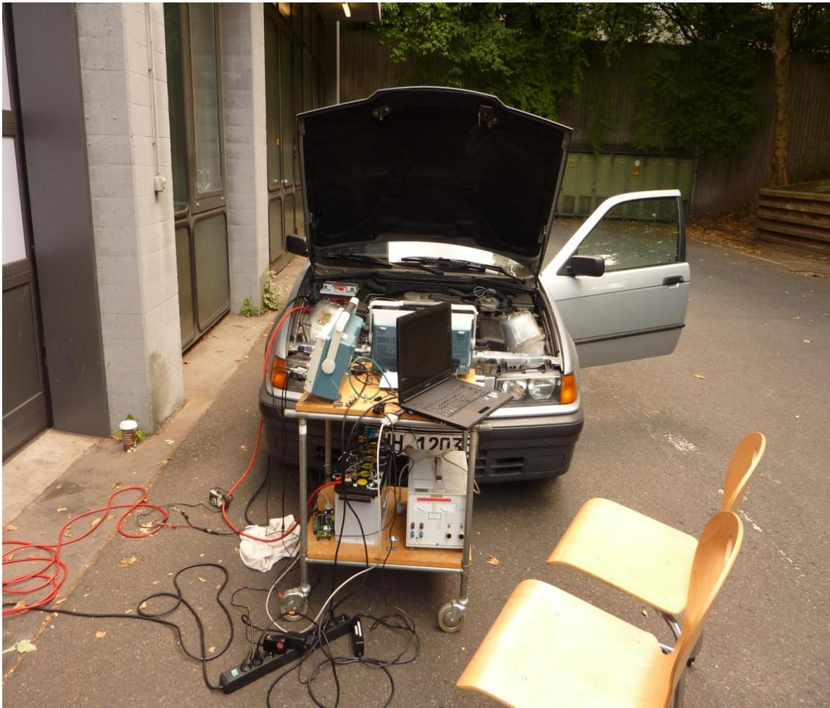
Abb. 6.3 Adaptierte Fahrzeugbatterie und Messgeräte am Fahrzeug
